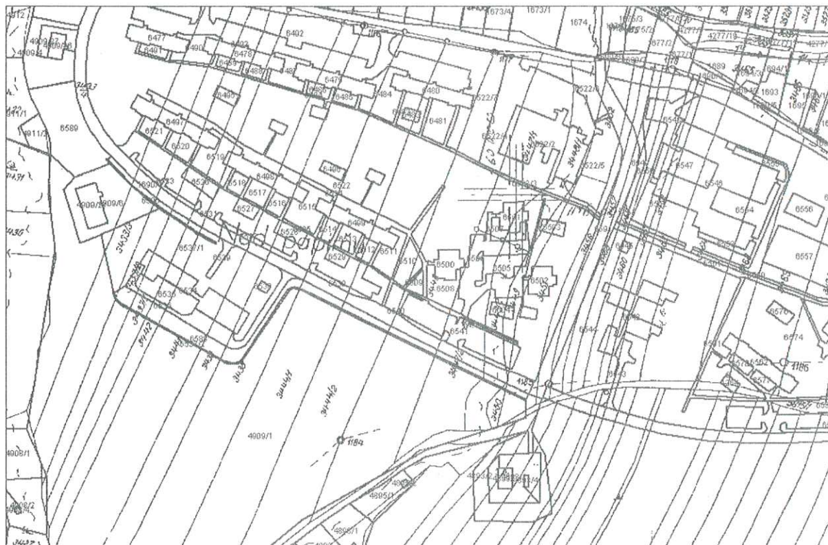
Obr. 2. Prekrytie vektorovej katastrálnej mapy a mapy pôvodného pozemkového katastra
