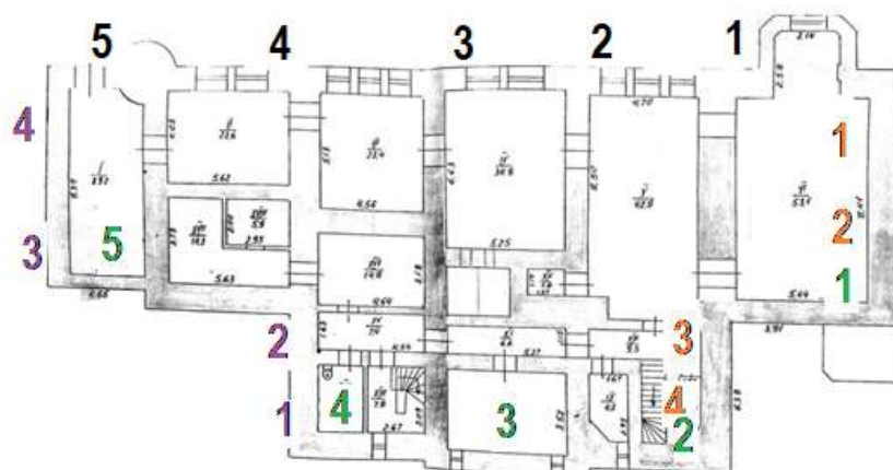
Obr.2: Pôdorys suterénu s vyznačením meracích bodov zavlhnutia, kreslil: K. Sikorski, 2019
